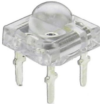
J'ai choisi un blanc chaud de 3000°K, la tension normale est de 3.2 v pour 30mA (soit 3500 mcd), mais dans ce montage spécifique, je survolte les LED a 3.8 v pour 70mA, cela ne chauffe pas même après 1H00 d'utilisation.
